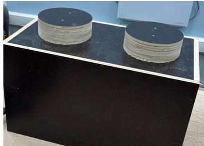
Прототип болларда для отливки в форме кирпичика LEGO
